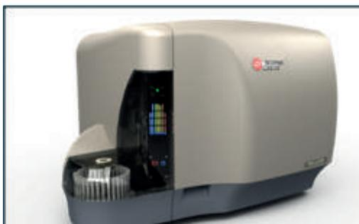
Fig. 3: il citofluorimetro in uso presso la Bios SpA capace di valutare fino a 10 fluorescenze in contemporanea. Da [www.beckman.com](http://www.beckman.com)
